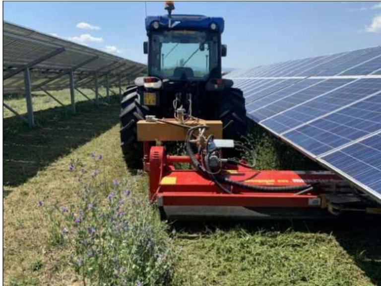
**Figura 10** Trinciatura del cotico erboso con barra falciante
