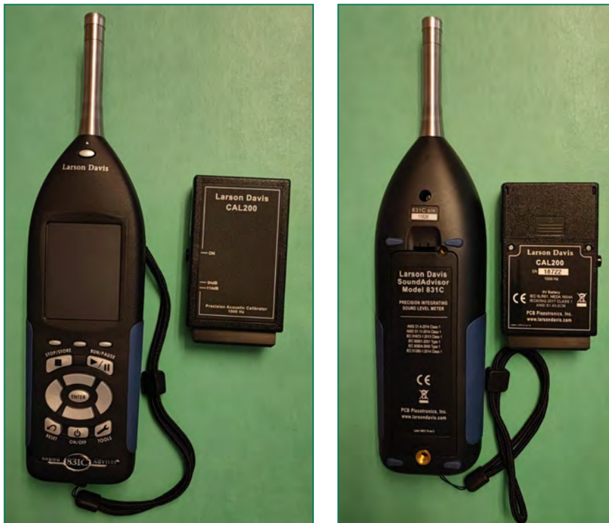
Figura 11: Strumentazione utilizzata per indagine acustica; fonometro e calibratore.
