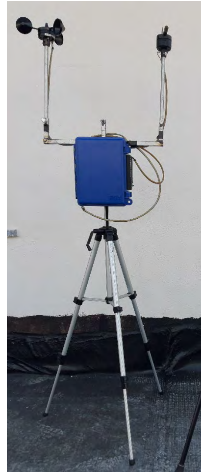
Figura 12: Stazione meteo portatile di altezza media 1,5 s.l.t. per il monitoraggio dei parametri anemologici di sito durante l'indagine fonometrica. Specifiche tecniche del Logger NRG Symphonie e dei sensori NRG #40 Maximum Anemomter e NRG 200P Wind Vane
