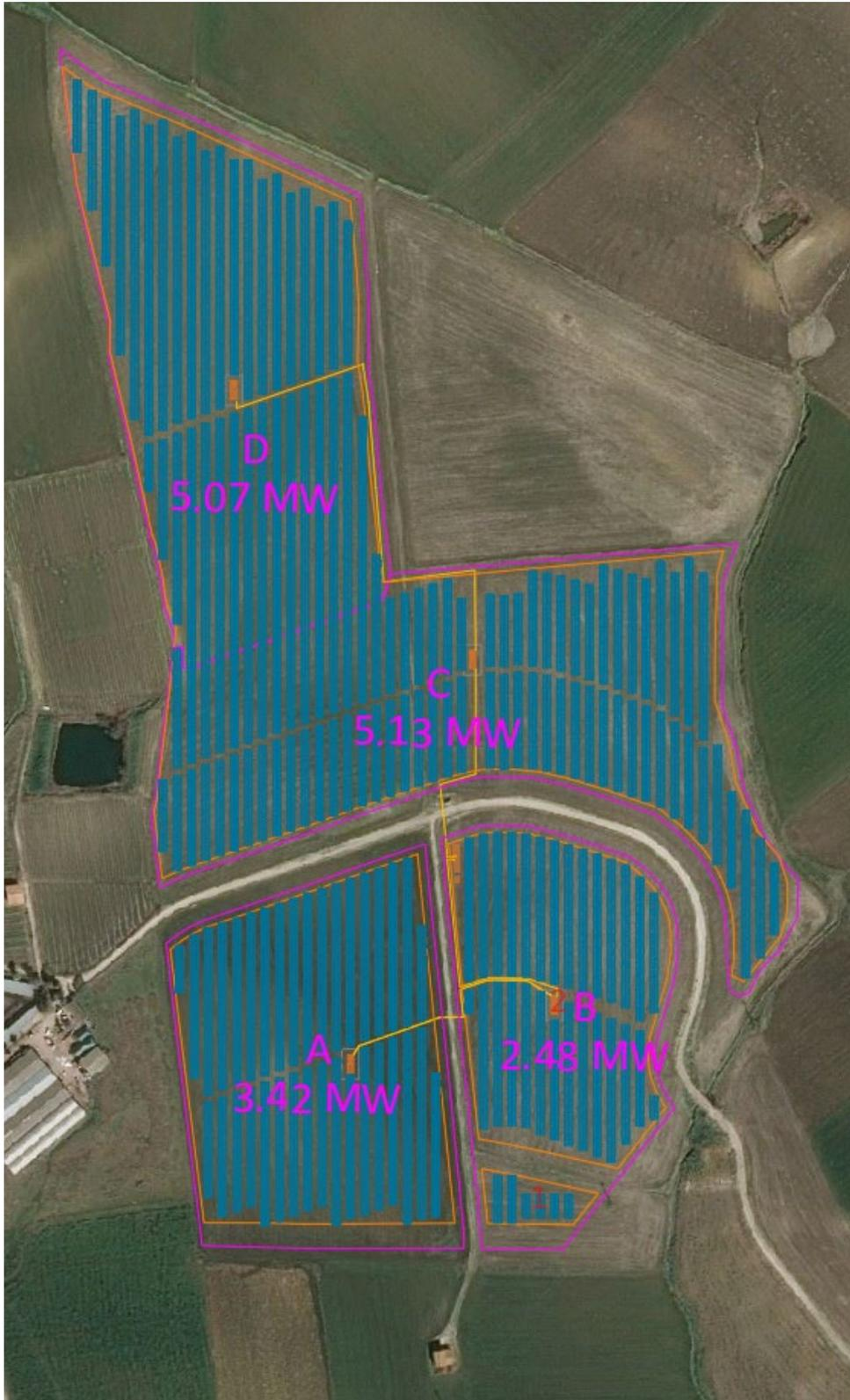
*Figura 3: Layout del campo Agro-fotovoltaico e suddivisione in sottocampi*
