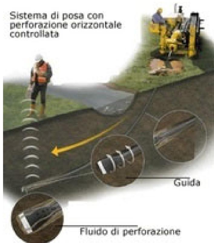
*Figura 29 - Schema tipo della tecnologia T.O.C.*
