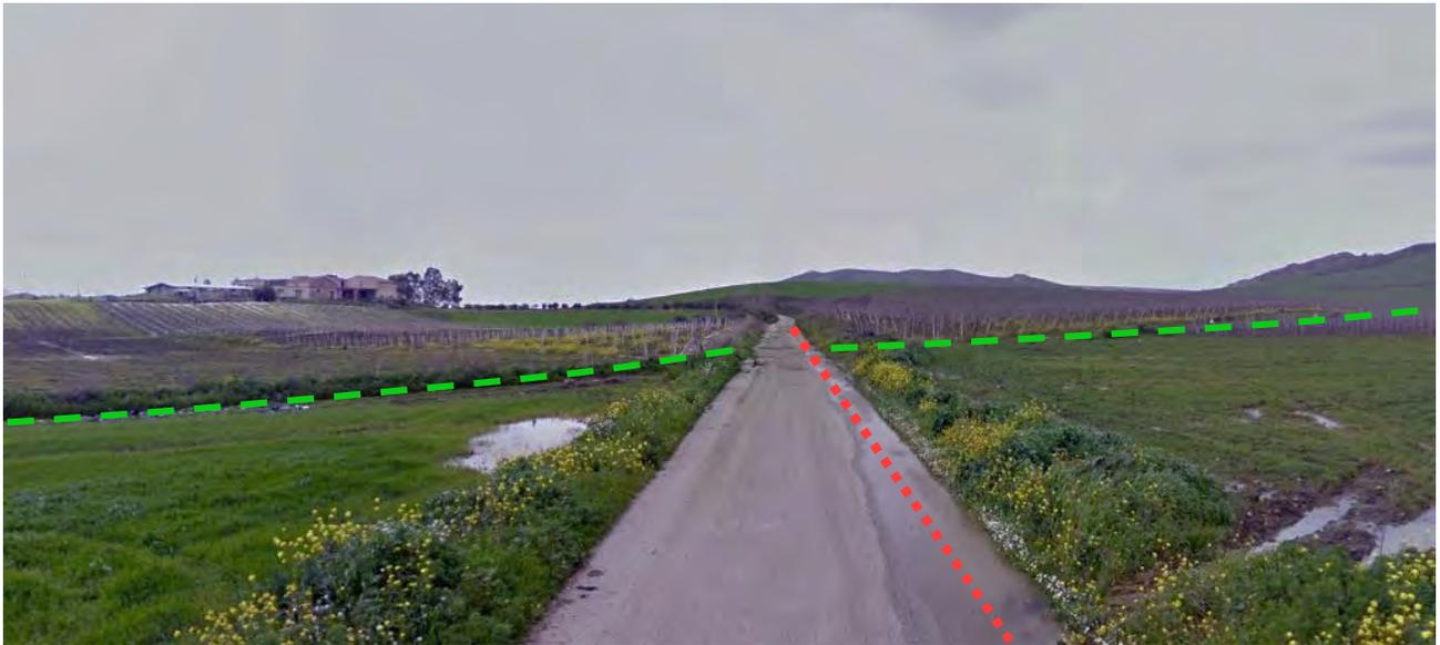
**Figura 53 - La foto simulazione in forma schematica il tracciato del cavidotto sulla strada provinciale asfaltata, mentre in diagonale, in verde, è visibile la traccia della trazzera, già interrotta dalla strada esistente pertanto si dimostra che non verrà a crearsi alcuna interferenza tra il tracciato del cavidotto in progetto, che sarà interrato sulla strada asfaltata e la trazzera stessa**
