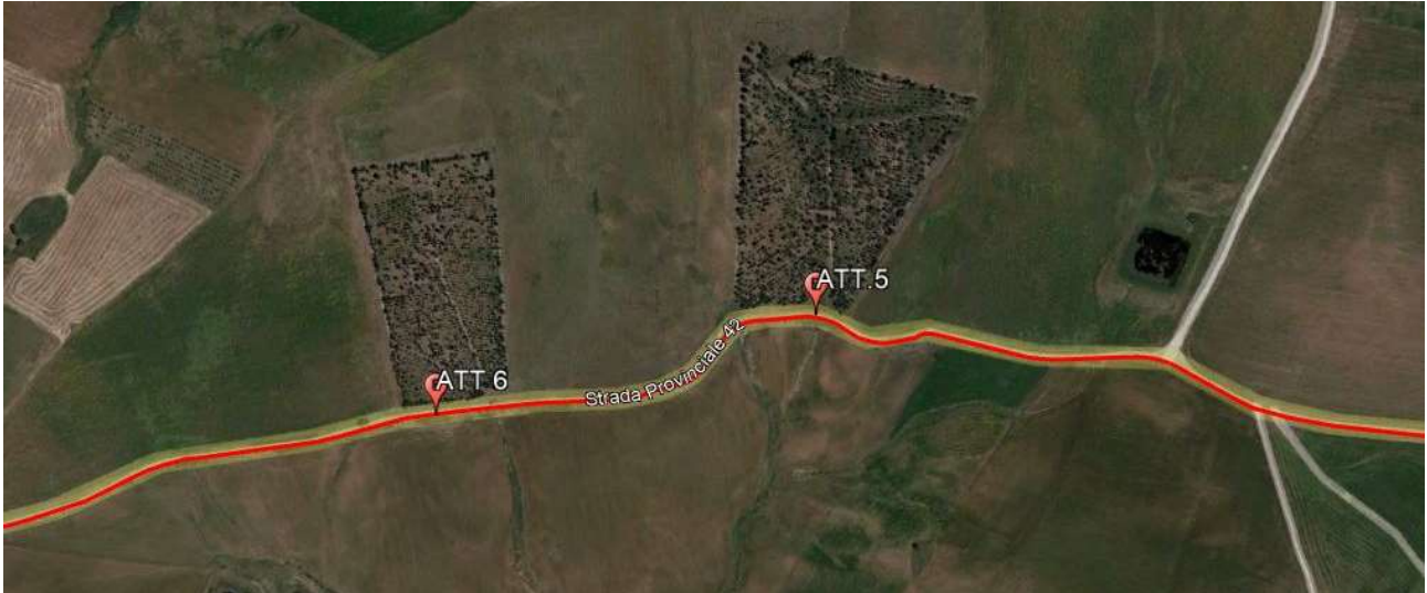
Figura 71 - Nell' immagine si inquadrano i punti della potenziale interferenza del cavidotto (in rosso), con l'area boscata di margine, lungo la provinciale 42.
