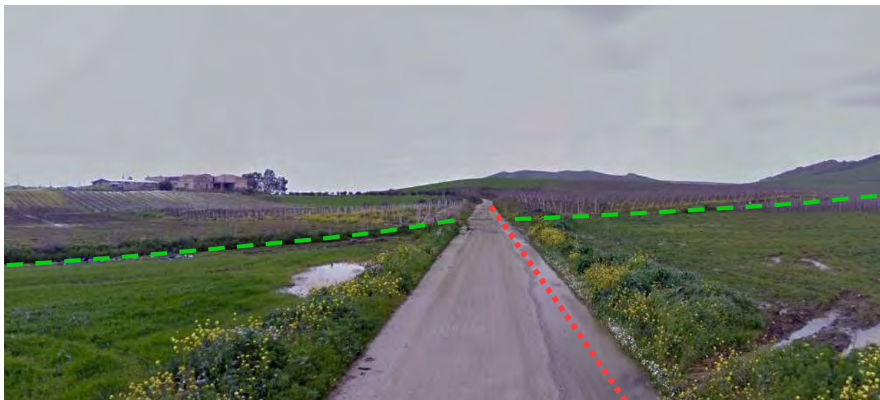
Figura 70 - La foto simulazione in forma schematica il tracciato del cavidotto sulla strada provinciale asfaltata, mentre in diagonale, in verde, è visibile la traccia della trazzera, già interrotta dalla strada esistente pertanto si dimostra che non verrà a crearsi alcuna interferenza tra il tracciato del cavidotto in progetto, che sarà interrato sulla strada asfaltata e la trazzera stessa
