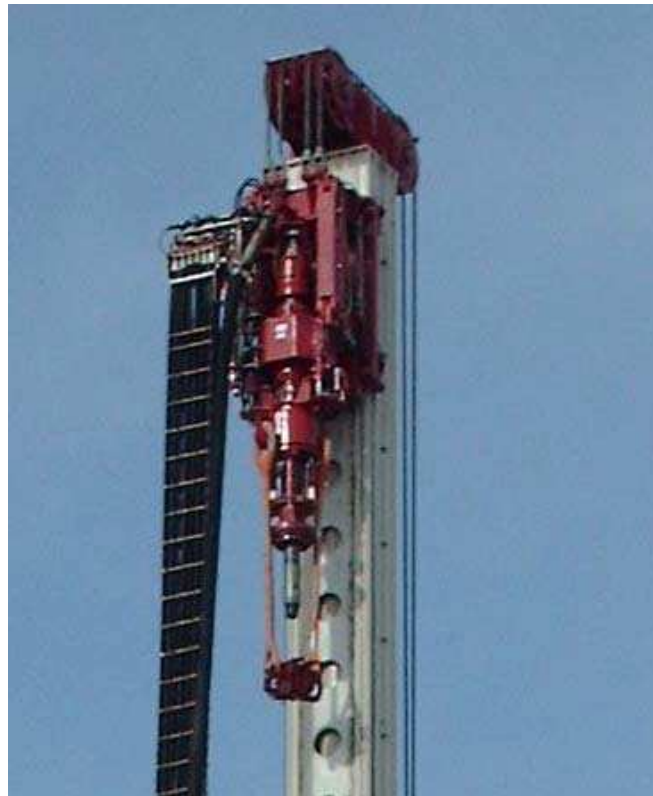
Figura 4-7: Top Drive dell'impianto HH220
