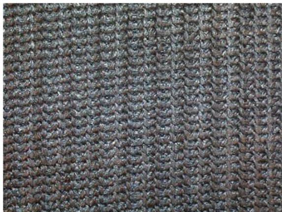
Figura 2-5: dettaglio della maglia in fibra metallica
