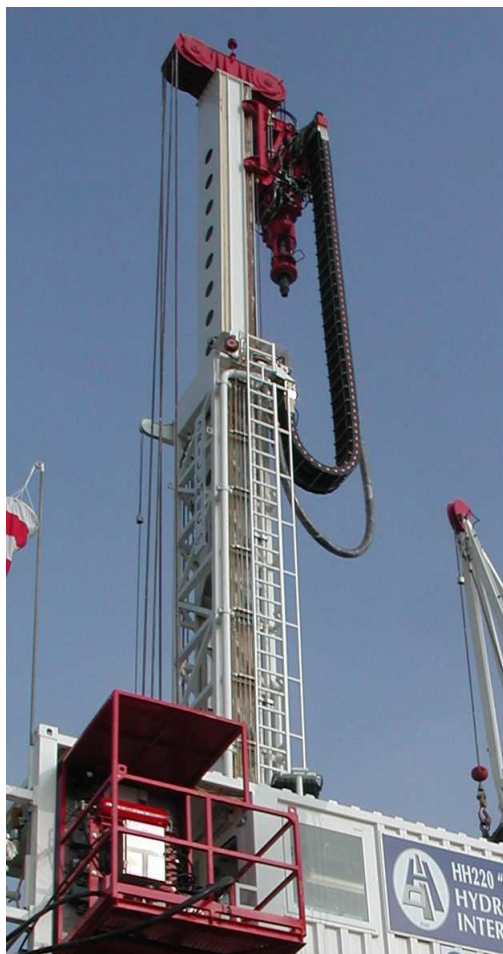
Figura 4-5: Sistema di sollevamento HH220
