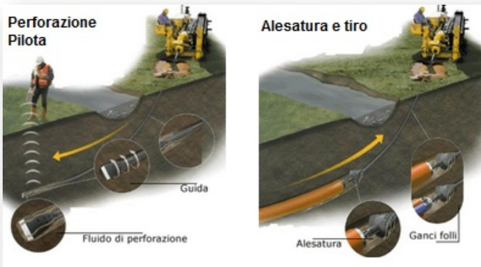
Figura 24 - tecnologia di trivellazione orizzontale controllata (TOC)
