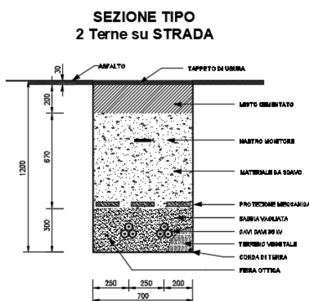
Figura 3-8- Sezione tipo cavidotto su strada
