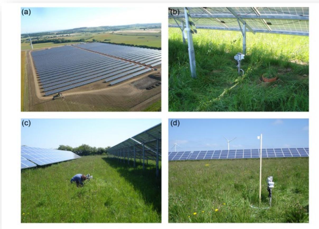
Figura 23- (a) foto aerea del Westmill Solar Park; (b) Under: punto di rilevamento sotto i moduli; (c); Gap: punto di rilevamento tra i filari di moduli; (d) Control: punto di rilevamento esterno
