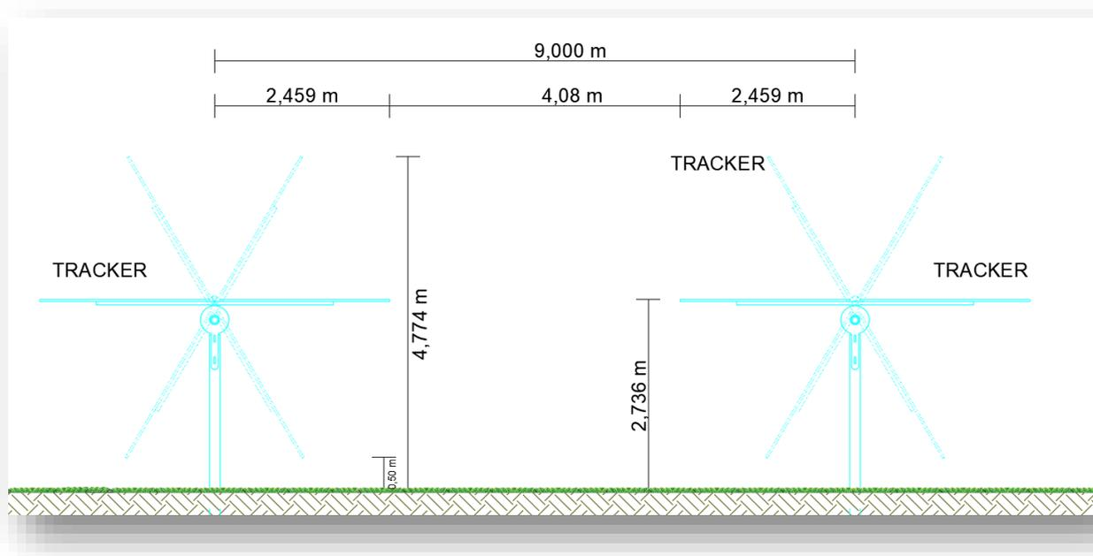
Figura 18– Sezione tipo impianto
