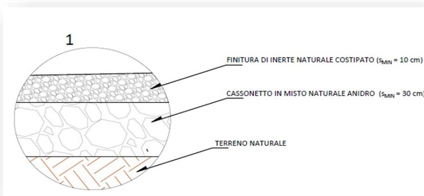
Figura 20- Estratto elaborato (Sezione stradale tipo)
