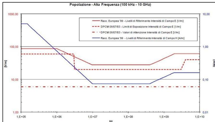
Figura 12. – Livelli esposizione Alta Frequenza (100Hz – 10 GHz).
