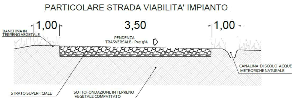
Figura 3: Sezione stradale della viabilità interna d'impianto – Strada sterrata
