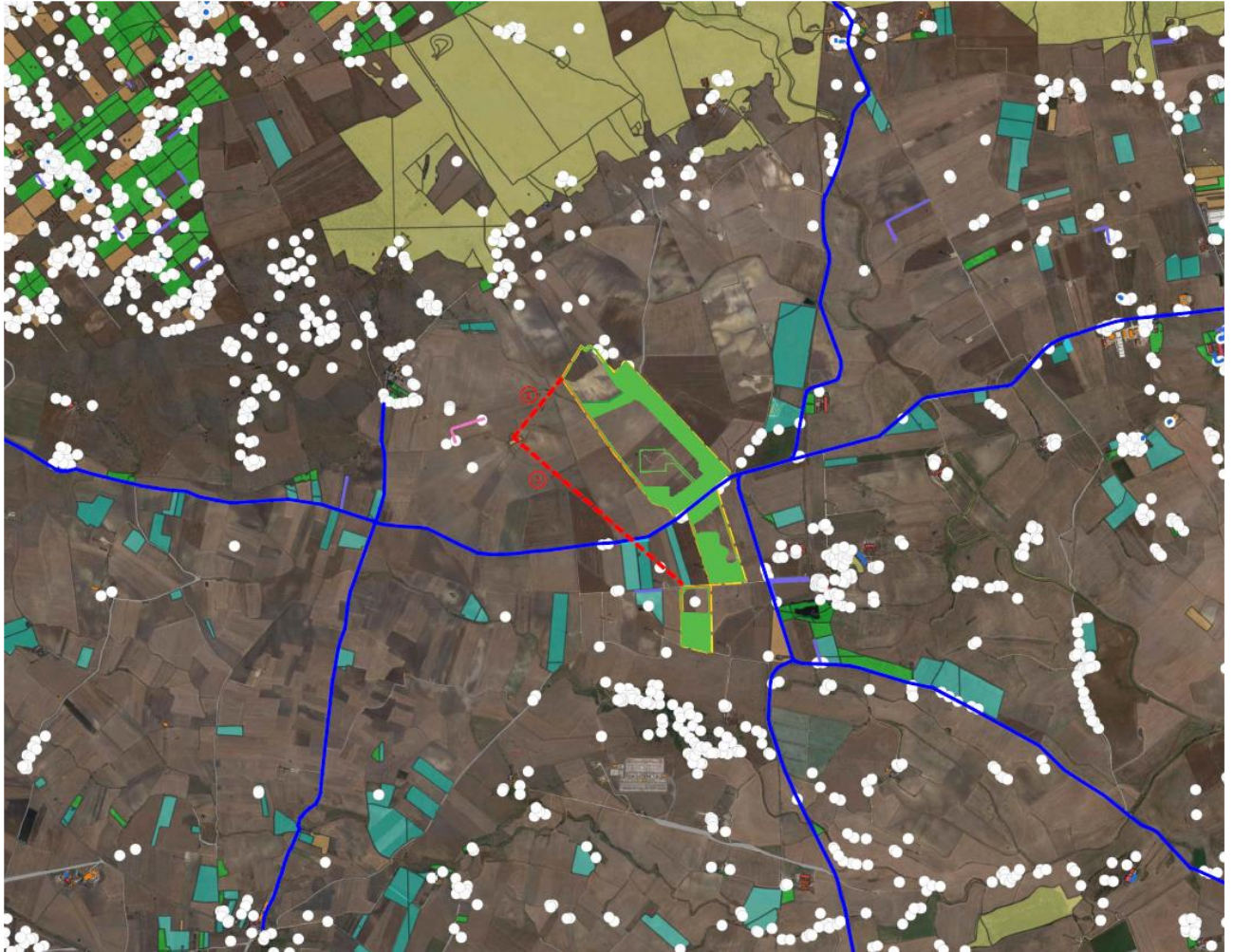
Figura 25: Analisi visiva dell'area di intervento con mappatura delle interferenze esistenti e opere di mitigazione a progetto da Monachelle
