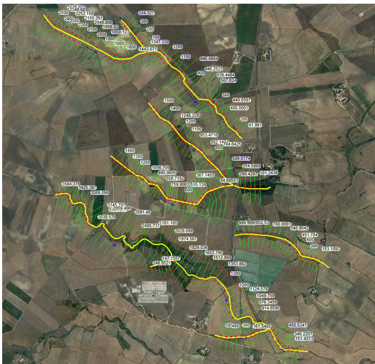
Figura 23: Risultati dello studio di compatibilità idrologica ed idraulica effettuato per il reticolo presente nell'intorno dell'area di impianto
