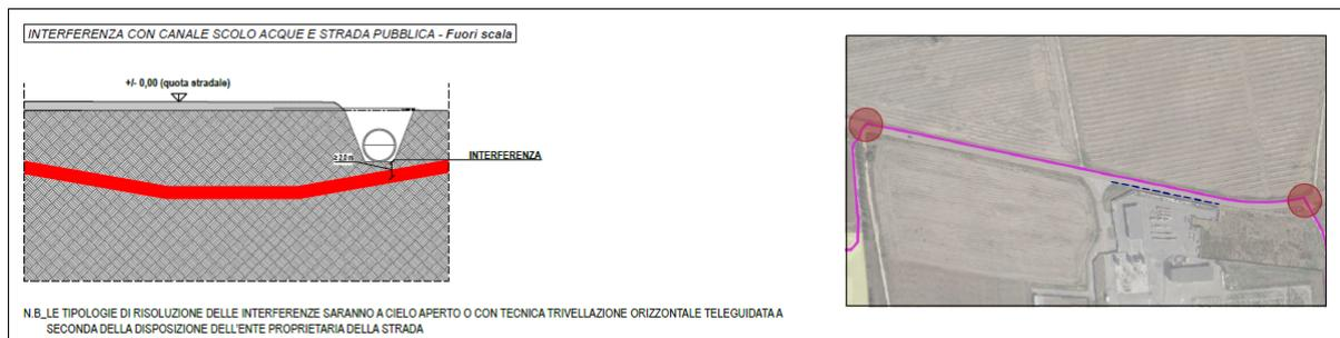
Figura 54: Interferenze n° 7, 7a – attraversamenti canali scolo acque e strada pubblica con tecnica T.O.C.
