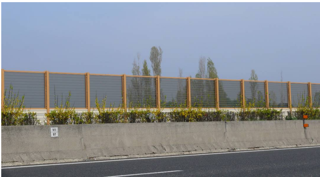
Figura 1.2.5/6 Esempio di barriera con pannelli trasparenti con trattamento anticollisione dell'avifauna mediante strisce satiniate ottenute per abrasione
