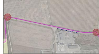
N.B. LE TIPOLOGIE DI RISOLUZIONE DELLE INTERFERENZE SARANNO A CIELO APERTO O CON TECNICA TRIVELLAZIONE ORIZZONTALE TELE GUIDATA A SECONDA DELLA DISPOSIZIONE DELL'ENTE PROPRIETARIA DELLA STRADA
