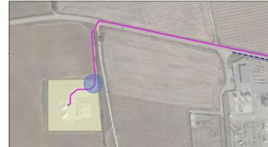
N.B. LA TIPOLOGIA DI RISOLUZIONE DELLA INTERFERENZA SARÀ CON TECNICA TRIVELLAZIONE ORIZZONTALE TELE GUIDATA
