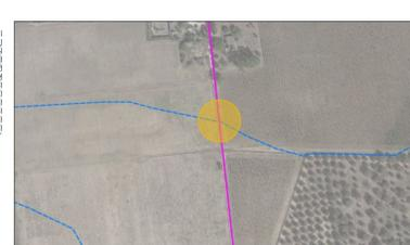
PRIMA DI ESEGUIRE I LAVORI DI INTERRAMENTO DEL CAVIDOTTO ELETTRICO SI PROVVEDERÀ ALL'ESECUZIONE DI UN SAGGIO NEL PUNTO DI INTERFERENZA CON LA TUBAZIONE PER VERIFICARNE L'ESATTA POSIZIONE, PROFONDITÀ DI POSA E DIAMETRO
