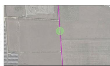
PRIMA DI ESEGUIRE I LAVORI DI INTERRAMENTO DEL CAVIDOTTO ELETTRICO SI PROVVEDERÀ ALL'ESECUZIONE DI UN SAGGIO NEL PUNTO DI INTERFERENZA CON LA TUBAZIONE PER VERIFICARNE IL DIAMETRO
