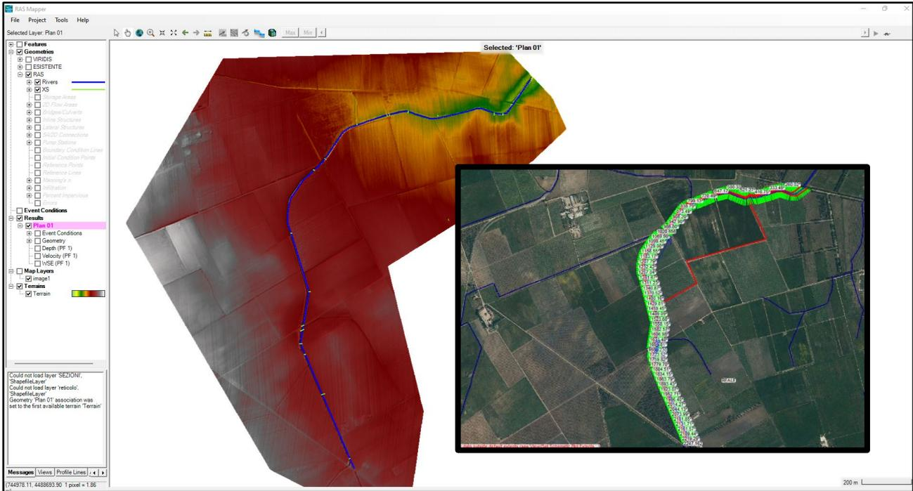
Creazione della geometria sulla base del DTM del rilievo LIDAR e delle sezioni rilevate
