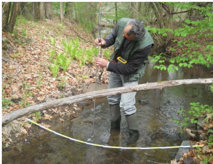
Figura 3/1 - Misura di portata con micromulinello (Borra della Massa)
