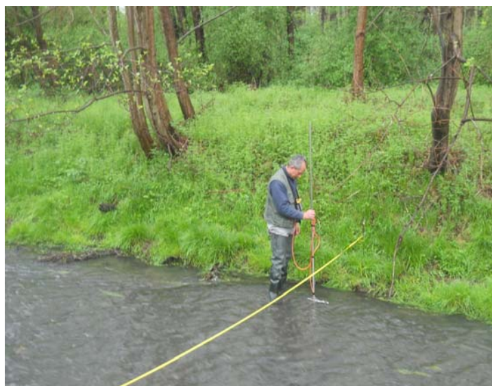
Figura 3/2 - Misura di portata con mulinello ordinario (rio Ribes).
