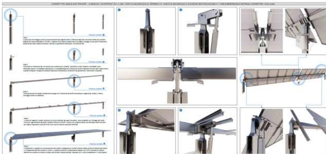
Figura 9: particolari costruttivi dei Tracker
