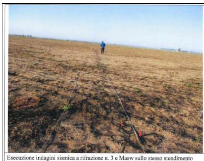
Figura 75: Foto 5 e 6- Esecuzione del profilo sismico a rifrazione e della Indagine Masw n.3
