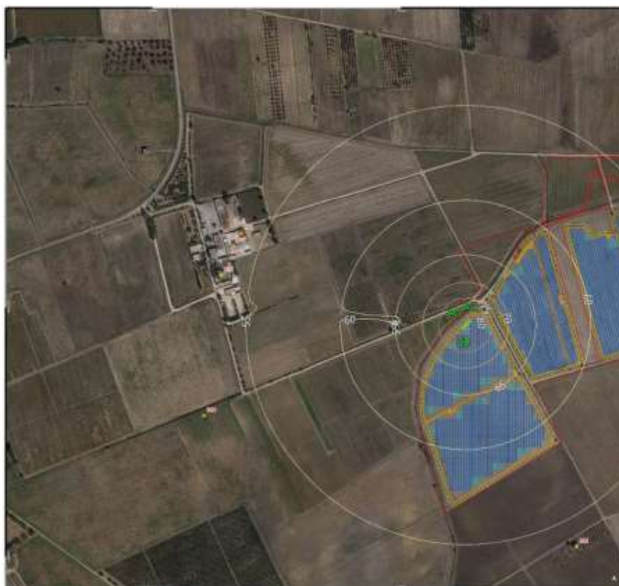
Figura 123: Calcolo delle isofone nello scenario di cantiere ipotizzando la contemporanea attività della Fase 6 posa delle cabine con l'impiego di autogru (AG) e autocarro (AC), Fase 7 con l'impiego del cingolato battipalo (CB) nelle posizioni più critiche rispetto ai recettori R02, R03, R04, R05
