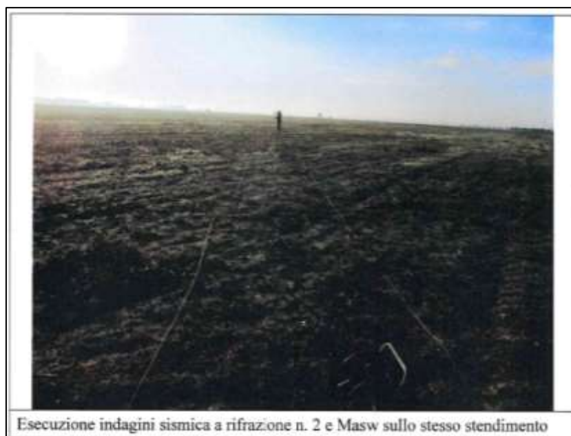
Figura 74: Foto3 e 4- Esecuzione del profilo sismico a rifrazione e della Indagine Masw n.2
