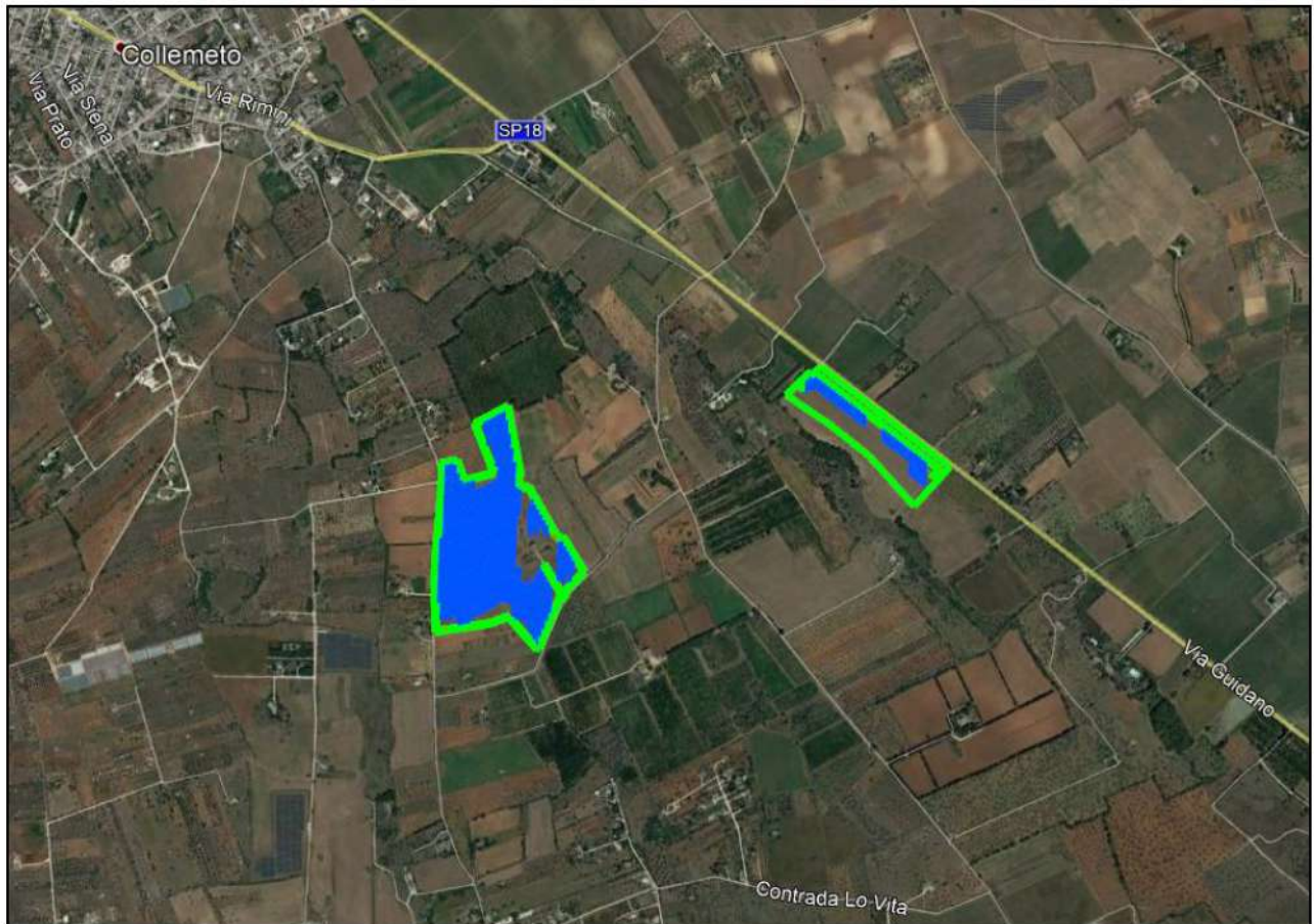
Figura 4: Inquadramento territoriale dell'area di progetto su ortofoto satellitare estratta da Google Earth con evidenza del perimetro delle arre di impianto (in colore verde) e del layout delle stringhe fotovoltaiche (in colore blu).
