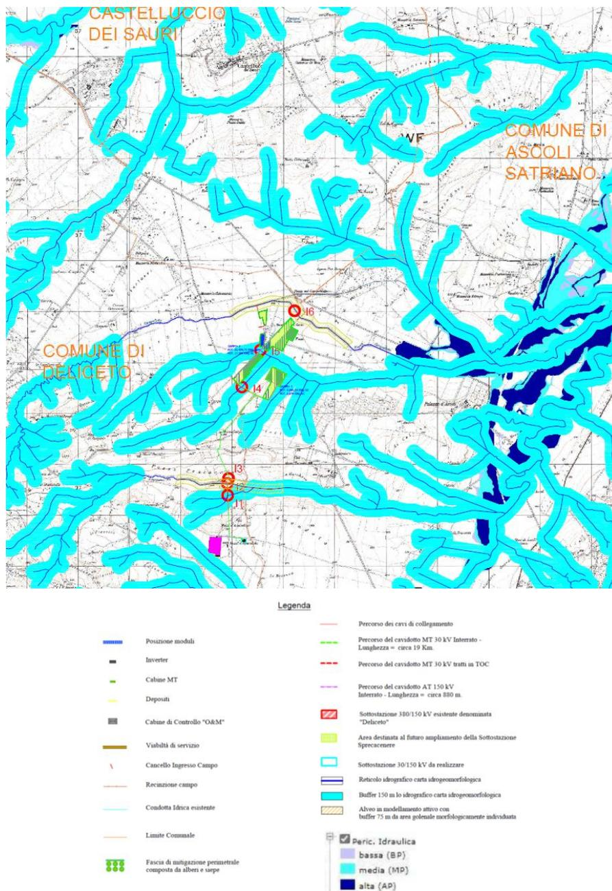
Figura 3 - Layout delle opere in progetto su IGM scala 1:25000 con individuazione dell'alveo in modellamento attivo e della fascia di pertinenza fluviale buffer in ciano Individuata con 150 metri contermini all'area golenale morfologicamente individuata artt. 6 e 10.
