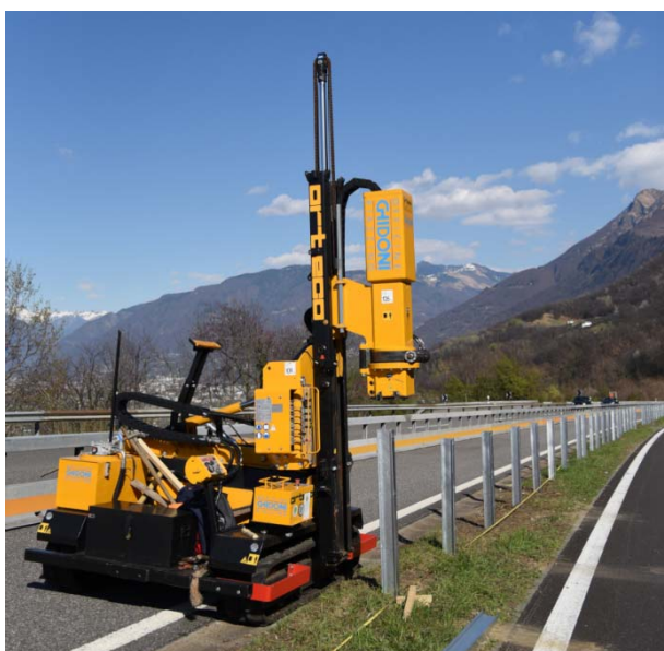
Fig.1 – Esempio di battipalo
