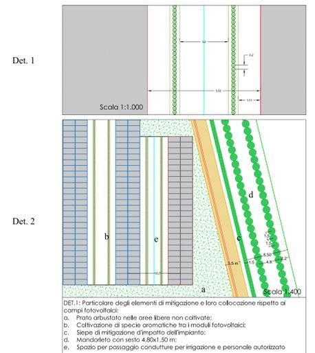
**Particolare profilo tipo del posizionamento delle strutture**
