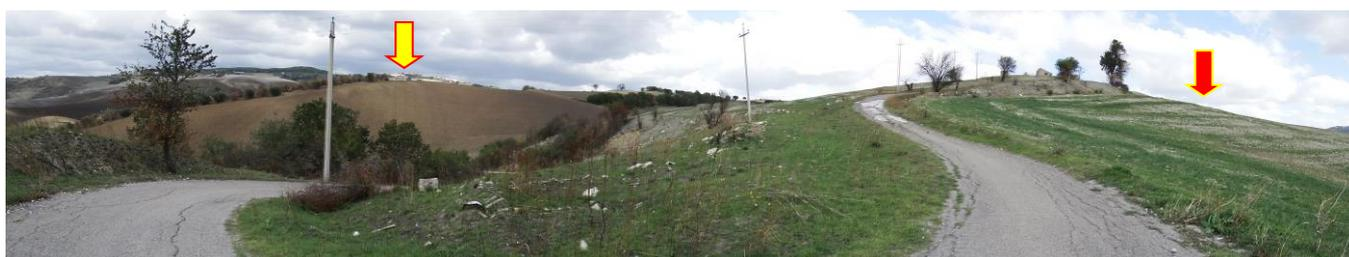
**Foto 4** – Foto panoramica dell’area. Ripresa effettuata dalla diramazione della SS 483 nei pressi del complesso di fabbricati di Masseria Graziani. In evidenza la matrice calcarea dei terreni a destra (freccia rossa) e la matrice argillosa dei terreni a sinistra (freccia gialla) che caratterizza l’area d’impianto.
