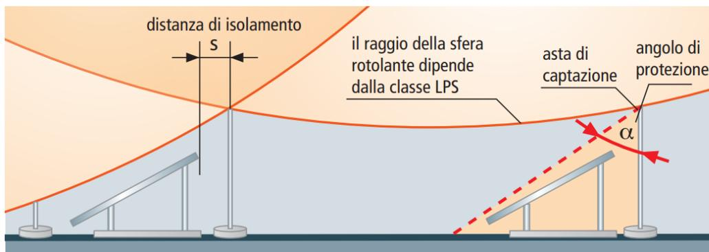
Queste aste di captazione formano un volume protetto che copre edifici operativi, contenitori modulari e cavi. A causa dell'accoppiamento induttivo delle interferenze, si consiglia di installare le scatole di derivazione del generatore montate su contenitori modulari e gli inverter nel modo più decentrato possibile rispetto al sistema di captazione.
