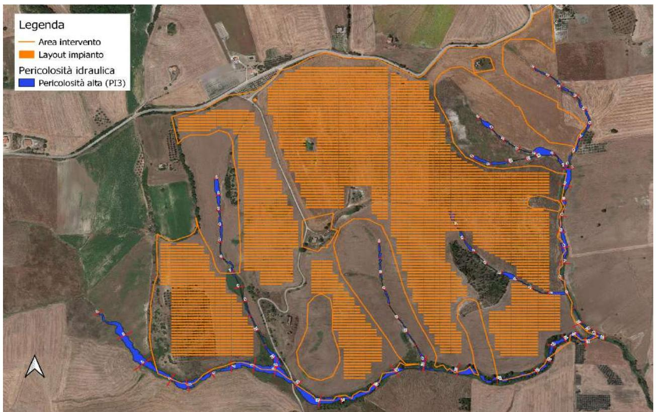
**Figura 16: Planimetria della pericolosità idraulica per un tempo di ritorno di 30 anni**
