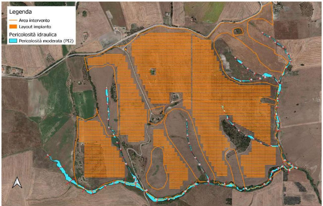
**Figura 17: Planimetria della pericolosità idraulica per un tempo di ritorno di 200 anni**
