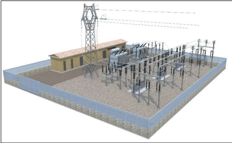
Figura 5-1 Sottostazione tipo con apparecchiatura ad alta tensione, trasformatore, quadri di media tensione e armadio di comando
