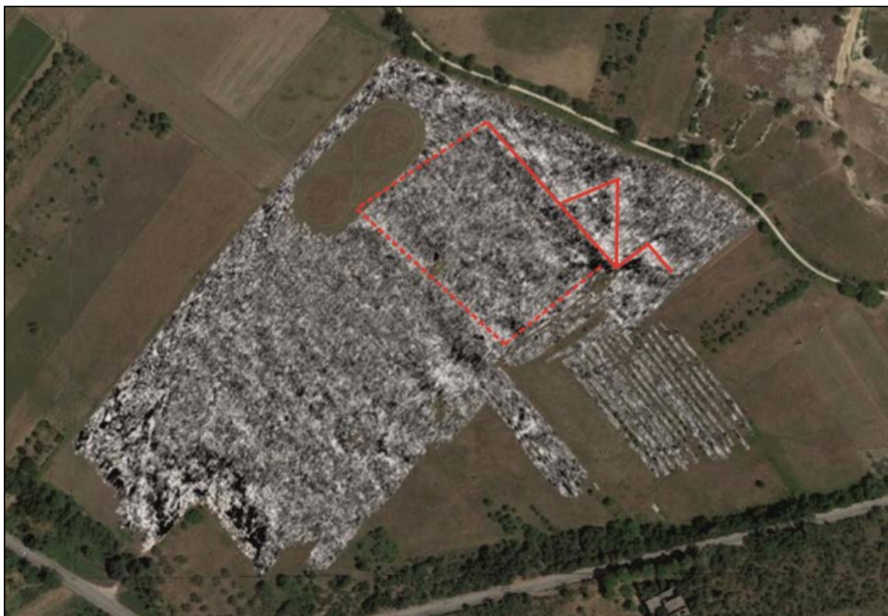
fig. 4. In rosso, interpretazione dati Georadar, strutture antropiche sepolte (sez. orizzontale – 1 m. d.p.c.).
