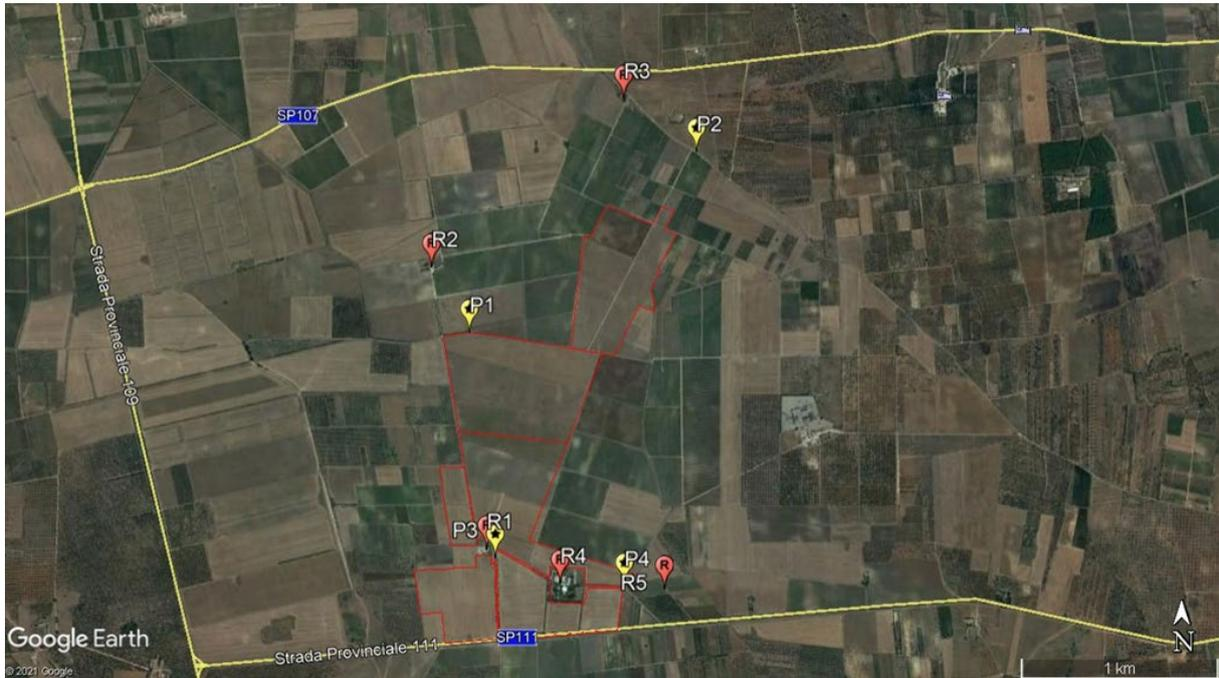
Figura 92: Zona d'influenza delle attività di cantiere con individuazione dei recettori (R) e punti di misura (P) considerati nella stima previsionale di emissione delle sorgenti proposta nella versione ortofotografica satellitare estratta da Google Earth
