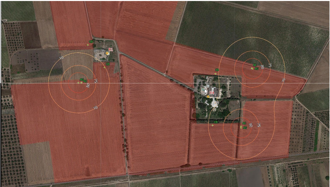
Figura 9 - Calcolo delle isofone nello scenario di cantiere Fase 6 durante la posa delle cabine ipotizzando l'impiego contemporaneo di autogru (AG) e autocarro(AC) nelle posizioni più critiche rispetto ai recettori R1 e R4
