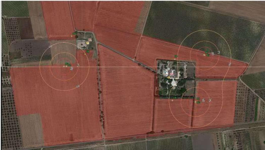
Figura 175: Calcolo delle isofone nello scenario di cantiere Fase 6 durante la poa delle cabine ipotizzando l'impiego contemporaneo di autogru (AG) e autocarro (AC) nelle posizioni più critiche rispetto ai recettori R1 e R4
