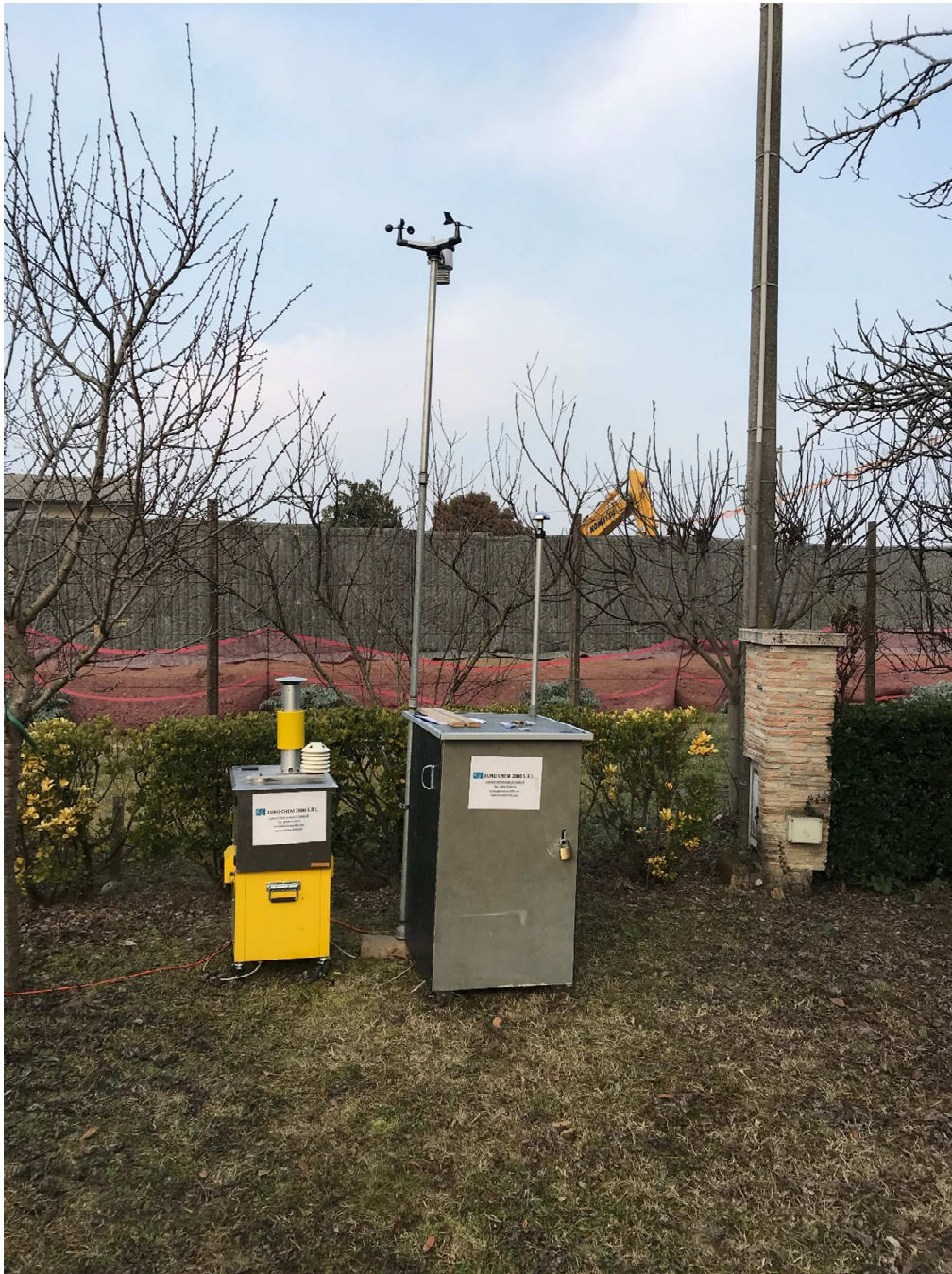
Vista stazione meteo, analizzatore e campionatore polveri assemblati
