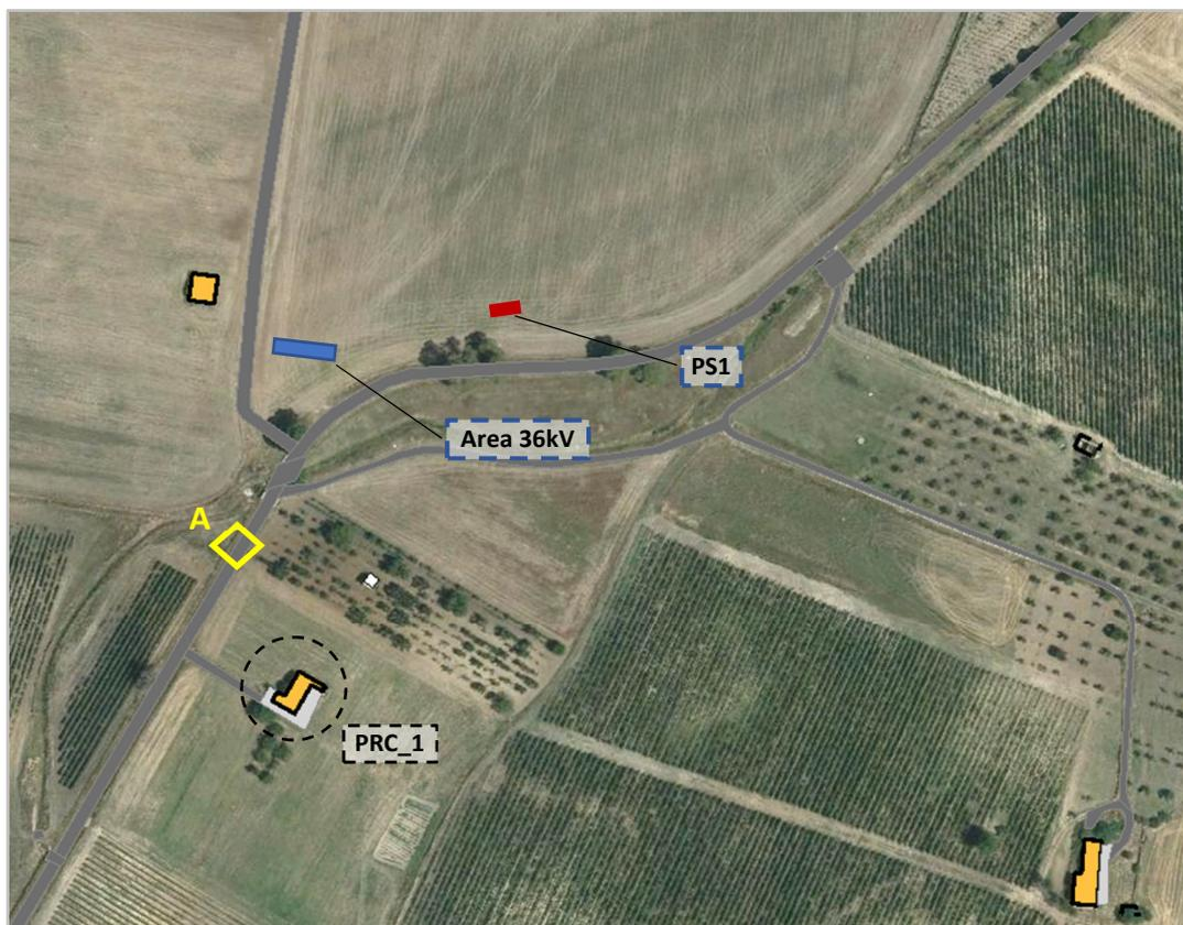
Fig.6: Ricettore PRC-1 e sorgenti (PS1 e area a 36 kV) su CTR e ortofoto (area sud impianto) e punto di misura A ante operam
