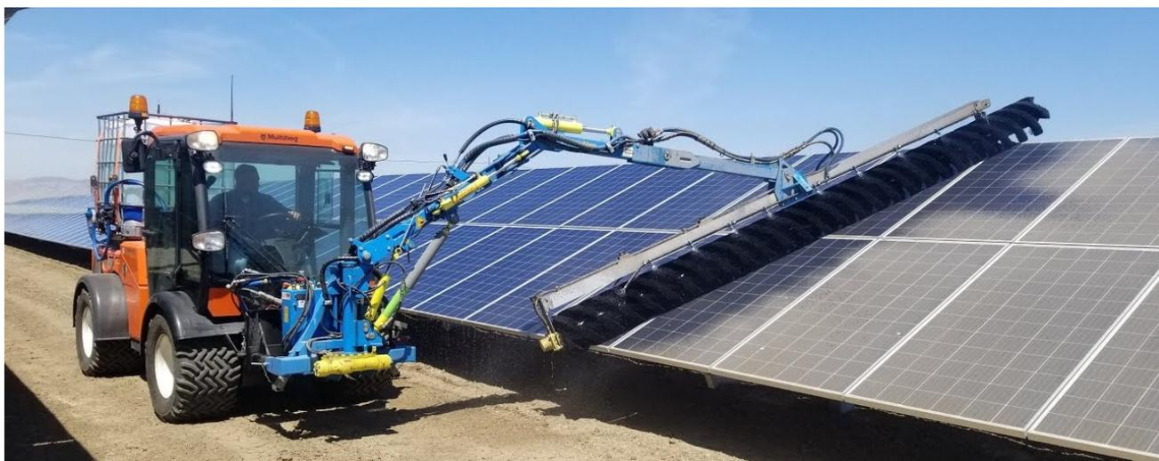
**Figura 50: dettaglio lavaggio pannelli**
