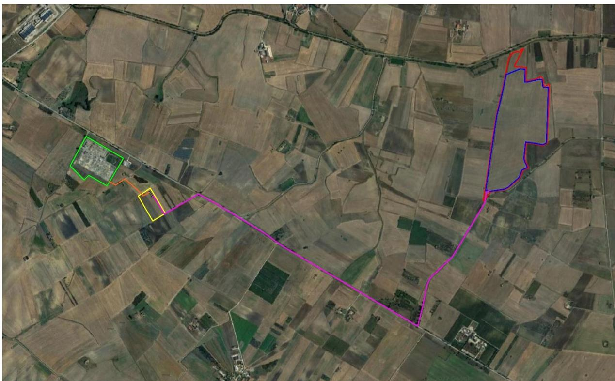
**Figura 1: Vista ortofoto dell'area oggetto dell'intervento (in rosso il perimetro dell'area di intervento impianto agrovoltaiico; in magenta il percorso del cavidotto interrato; in giallo la futura Stazione satellite a 36kV; in arancione il cavo AT di connessione fra area satellite a 36kV e la stazione Terna "lesce"; in verde scuro la Stazione Terna "lesce")**
