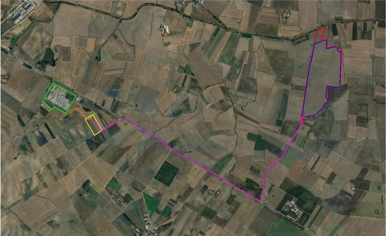
***Figura 1: Vista ortofoto dell'area oggetto dell'intervento (in rosso il perimetro dell'area di intervento impianto agrovoltaico; in magenta il percorso del cavidotto interrato; in giallo la futura Stazione satellite a 36kV; in arancione il cavo AT di connessione fra area satellite a 36kV e la stazione Terna "lesce"; in verde scuro la Stazione Terna "lesce")***
