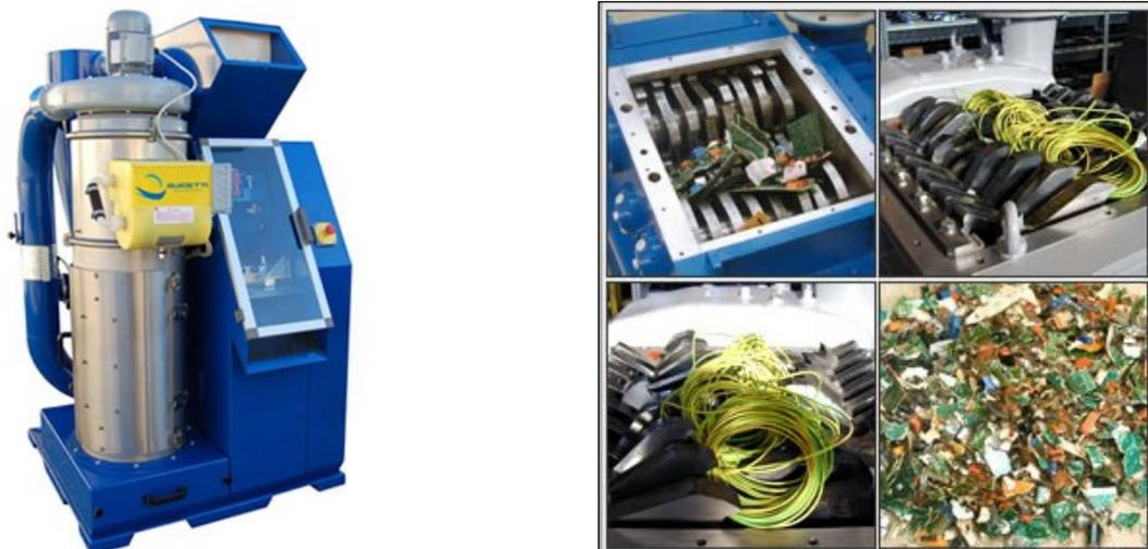
Macchinari simili saranno utilizzati anche per lo smaltimento delle apparecchiature elettroniche quali inverter, trasformatori, quadri elettrici. Il trattamento dei rifiuti da apparecchiature elettriche (RAEE) ed elettroniche è svolto in centri adeguatamente attrezzati, autorizzati alla gestione dei rifiuti e adeguati al "Decreto RAEE", sfruttando le migliori tecniche disponibili. Le attività di trattamento prevedono varie fasi, indicativamente:
