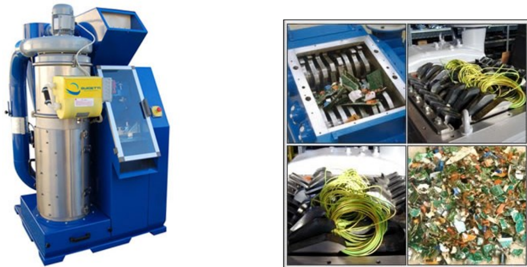
Figura 62: dettaglio processo disgregazione materiali
