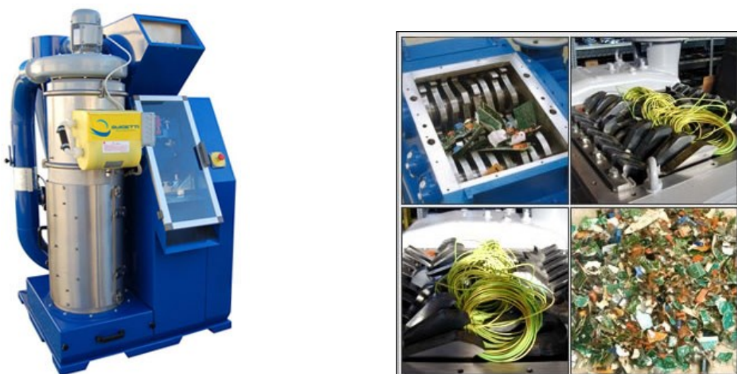
Figura 52: dettaglio processo disgregazione materiali
