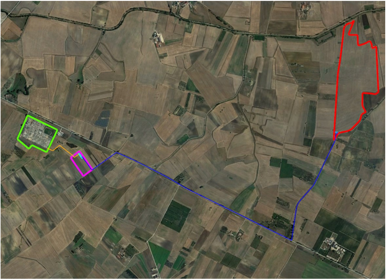
Figura 39 Particolare cavidotto SOLUZIONE 1
