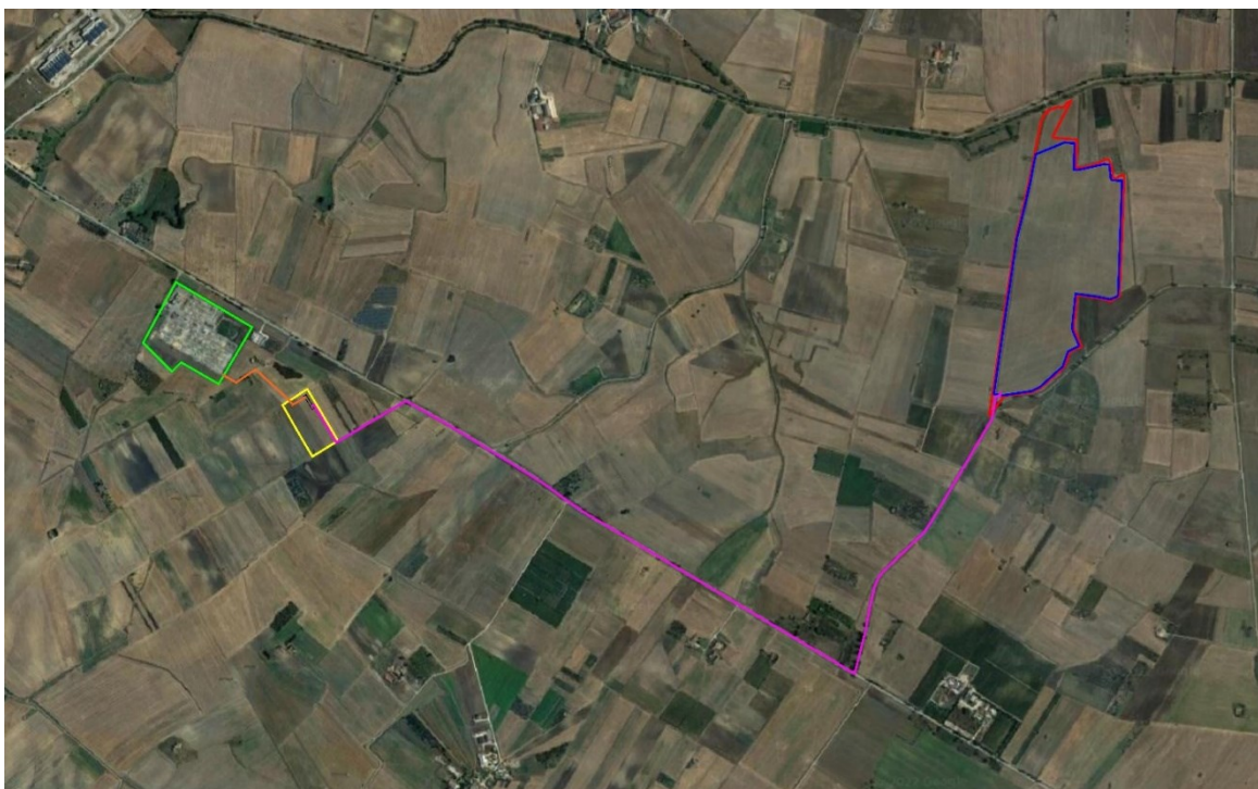
Figura 1: Vista ortofoto dell'area oggetto dell'intervento (in rosso il perimetro dell'area di intervento impianto agrovoltaico; in magenta il percorso del cavidotto interrato; in giallo la futura Stazione satellite a 36kV; in arancione il cavo AT di connessione fra area satellite a 36kV e la stazione Terna "lesce"; in verde scuro la Stazione Terna "lesce")
