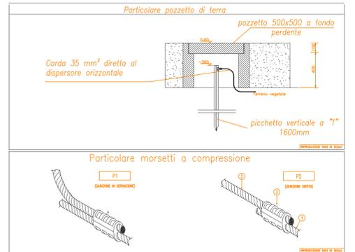
Componenti dell'impianto di terra della cabina di consegna/vettoriamento in riferimento al progetto
