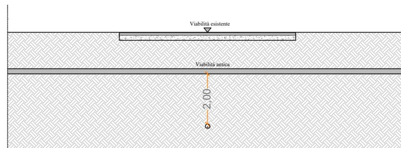
SEZIONE TRASVERSALE- ATTRAVERSAMENTO VIABILITA' ANTICA
