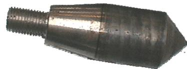
Nel corso della prova sono stati rilevati, per ogni 20 cm di avanzamento delle aste, il numero dei colpi necessari per l'infissione della punta conica.
