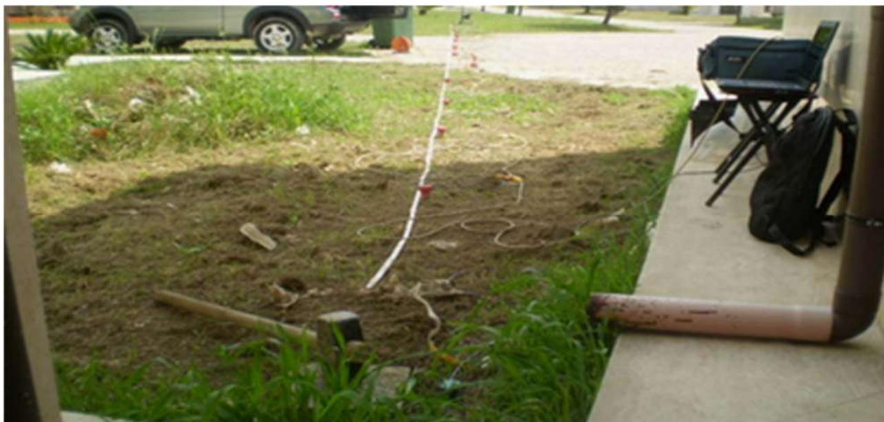
**Fig.2** – Esempio di stendimento sismico MASW
