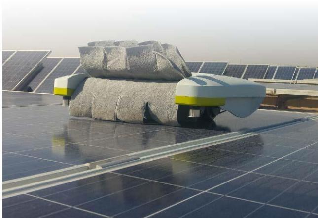
Figura 67: Robot T4 - Pulizia Moduli
