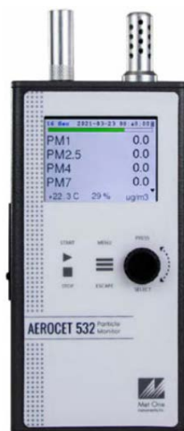
Strumentazione per la misura del particolato in continuo
