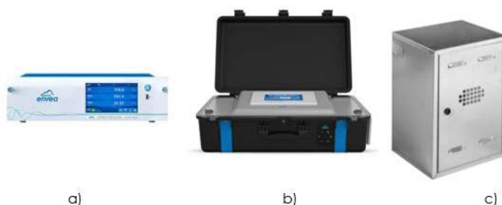
Stazione mobile per il monitoraggio degli inquinanti da traffico veicolare. a) Misuratore ossidi di azoto a chemiluminescenza; b) Misuratore CO a infrarossi; c) cassetta zincata protezione sonde.
