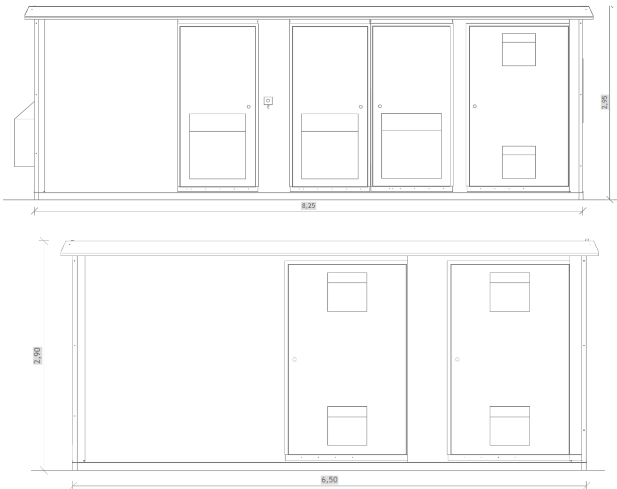
Figura 5. Pianta e prospetti della cabina di trasformazione
