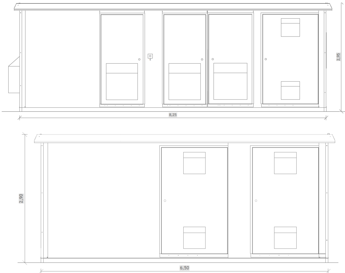
Figura 5. Pianta e prospetti della cabina di trasformazione
