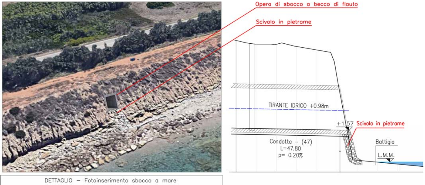
Figura 9 I. Schema tipologico del sistema di scarico a mare del collettore IN16.
