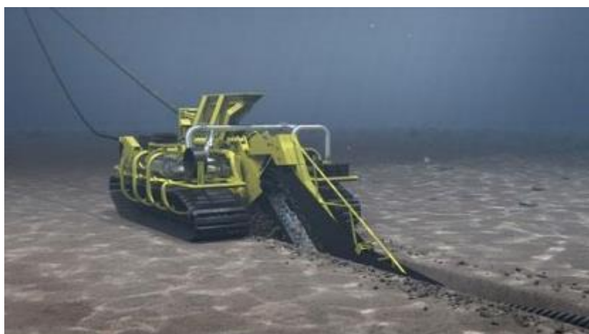
Figura 6-17: Sistemi protezione dei cavi per interrimento
