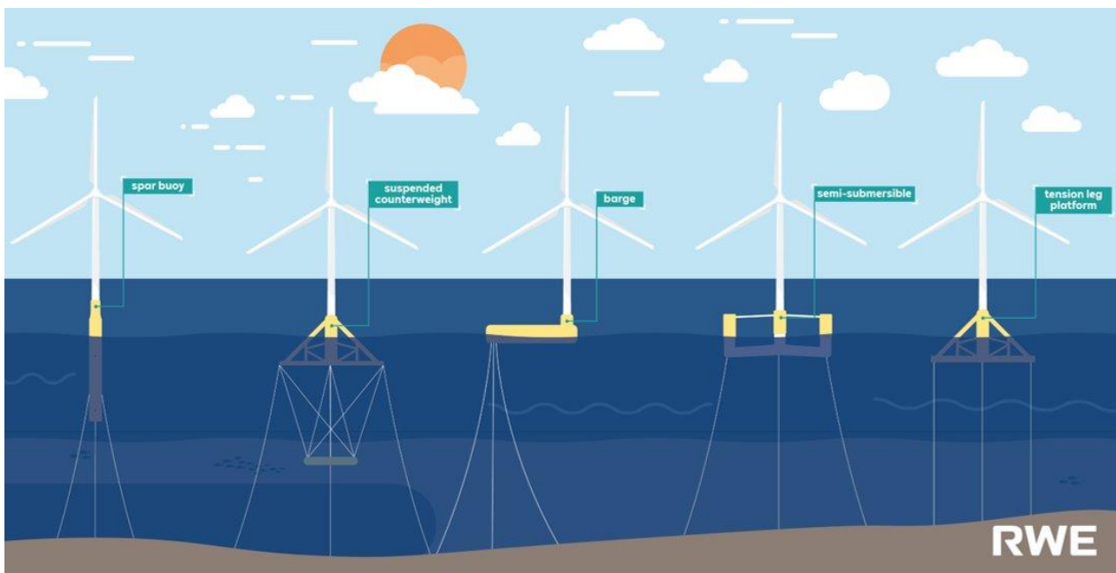
Figura 6-4: Tipologie di fondazioni galleggianti e struttura di galleggiamento della turbina (Fonte: /a22/, Capitolo 11)
