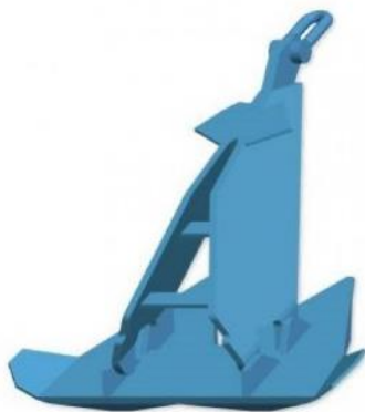
Figura 6-7: Esempio di ancora con trascinamento
