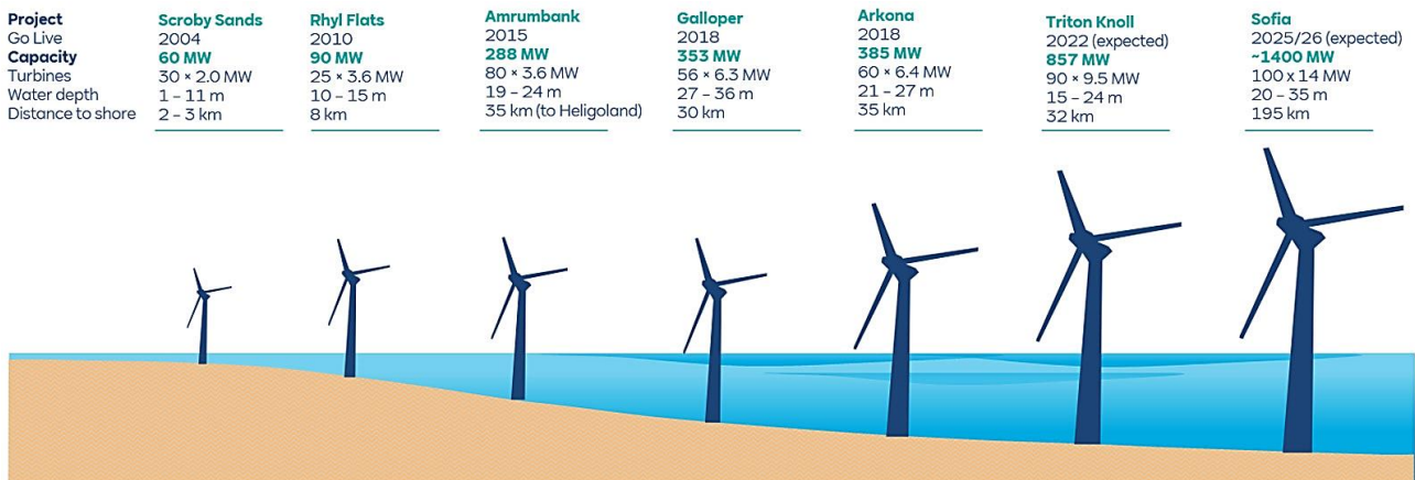
Figura 2-1: Evoluzione delle capacità complessive installate, numero e tipo di turbine impiegate, profondità delle acque e distanze dalla costa degli impianti eolici offshore sviluppati, costruiti ed operati da RWE e loro data di entrata in esercizio dal 2004 al 2026.
