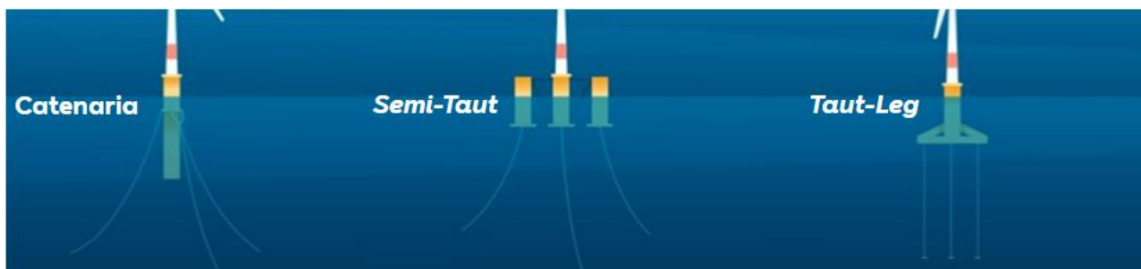
Figura 6-6: Esempi di sistemi di ancoraggio
